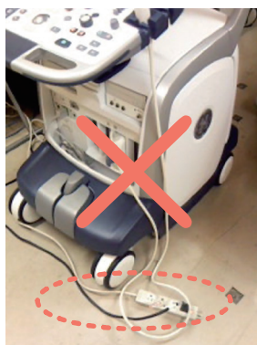
プローブと電源ケーブルが重なっている
