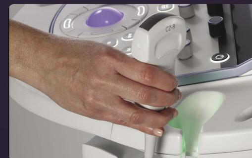
Выполняйте работу эффективнее с использованием функции активации Probe Respond, которая позволяет автоматически распознавать датчики и предустановки при извлечении датчика из держателя.
