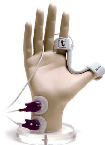
Kinemyographie (KMG) Nécessite 2 électrodes
