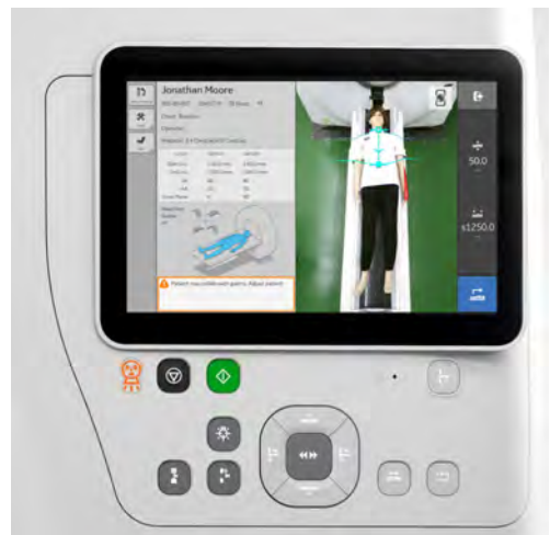
Automatische Zentrierung: Gantry ausrichten mit nur einem Klick.
